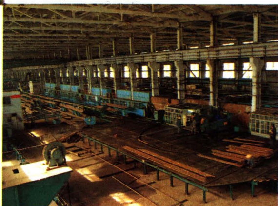
▼ 哈尔滨锅炉厂研制的“计算机数字控制锅炉蛇形管弯管自动线”获国家科技进步三等奖。
