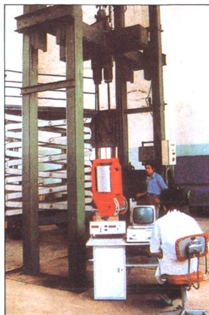
恒力支吊架测试台
