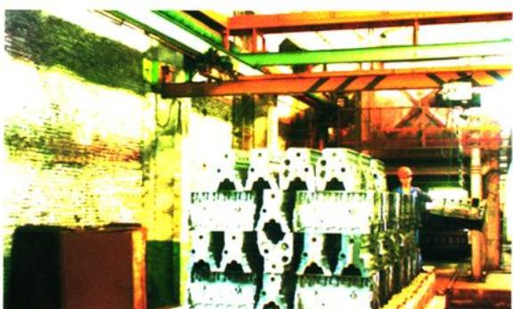
提升式退火炉（缸体装车）
