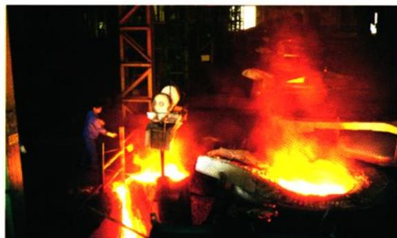
20吨工频炉炉群（出铁水）
