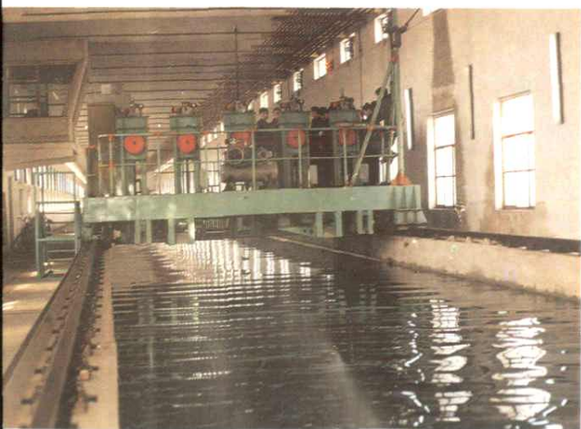
□黄委会水文局流速仪检定大厅 (任建华、方春燕摄)
