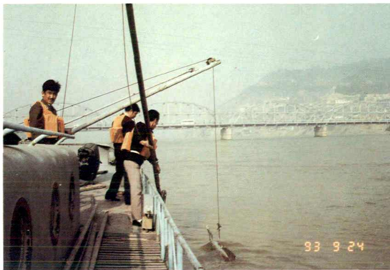
□兰州水文站职工船上 测流、取含沙量水样 (王清叶提供)
