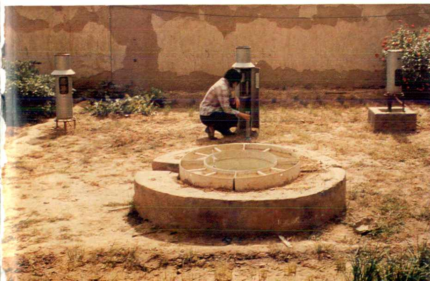
□白家川水文站职工观测蒸发 (黄河博物馆提供)
