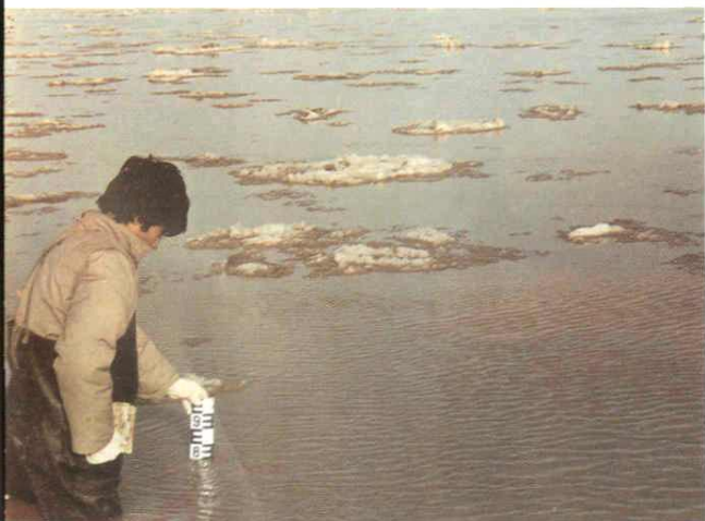
□头道拐水文站职工冰期观测水位 (王清叶提供)
