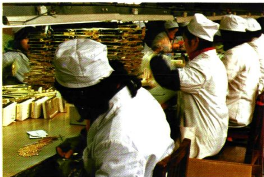
△ 机械闹钟总装配流水线
