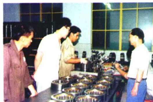
轴承检修选配检测作业
