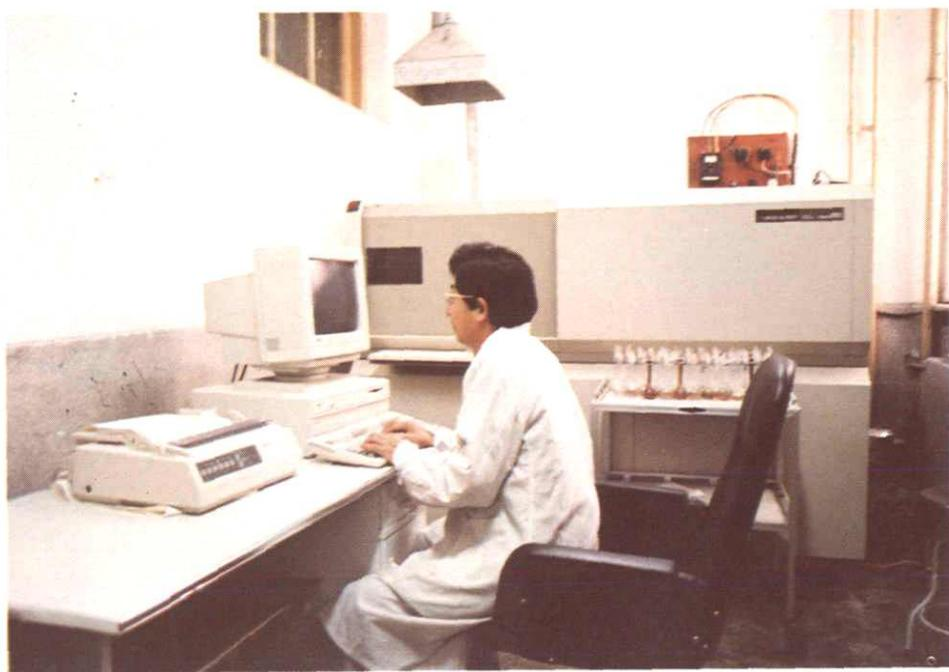
可分析 72 种元素的电感耦合等离子体发射光谱仪。
