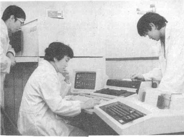
◀ 自贡铸钢厂从美国引进的 DV-4 型真空光电直读光谱仪。
