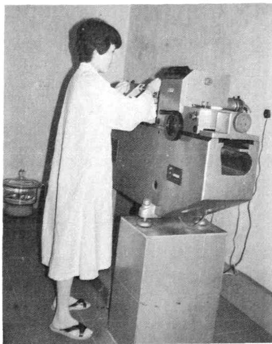
▲ 自贡市计量测试研究所检定员用高精度测长机进行大尺寸端度测量。
