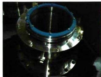
区科技企业大连华阳光大密封有限公司开发研制的专利产品高参数机械密封装置
