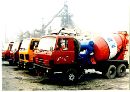
混凝土搅拌运输车
