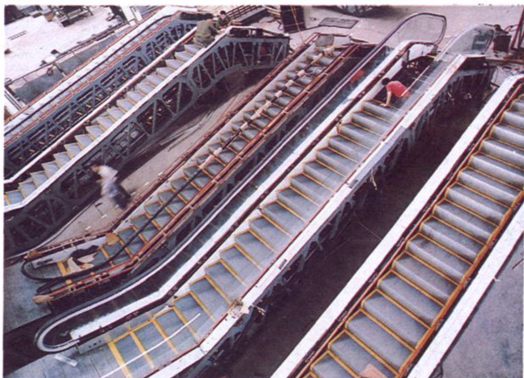
江西电梯厂组装线
