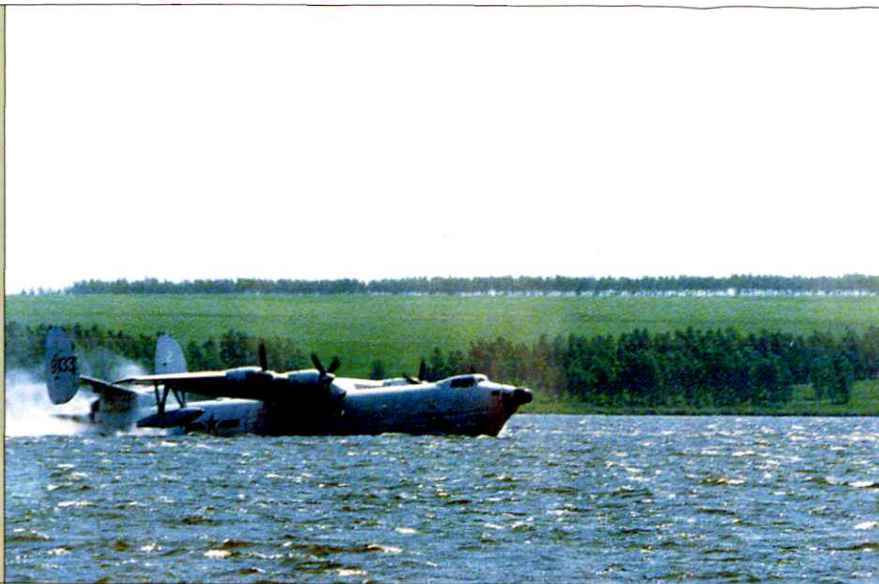
11. 由原林业部投资改装的空军水轰-5飞机在做吸水试验 (摄影 赵正利)
