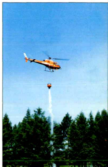
3. 吊桶灭火试验(根河航空护林站供稿)
