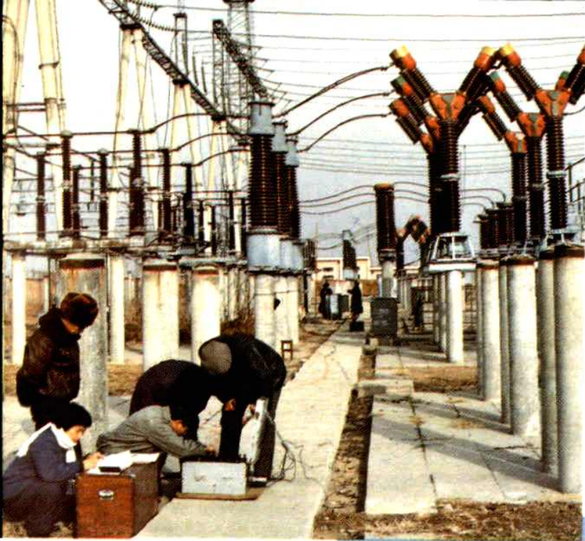
1986年保定供电局研制成功带电测量220千伏电流互感器介质损失角及电容量装置，荣获河北省电力工业局科技二等奖。
