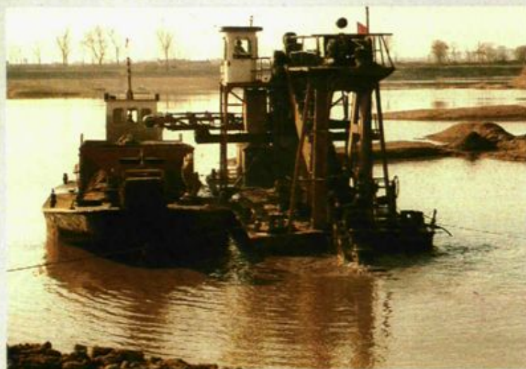
采砂船正在采砂作业，由驳船将砂石运送到岸边。
