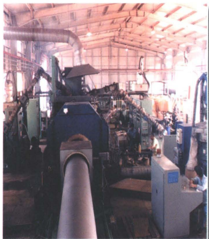
公司的防腐保温作业线
