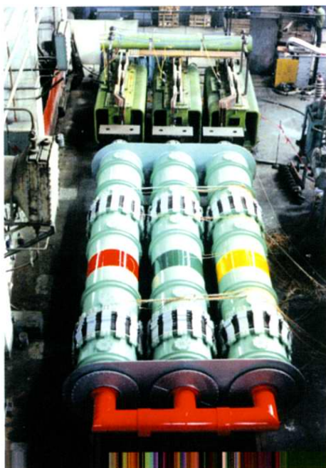
封闭母线温升实验现场
