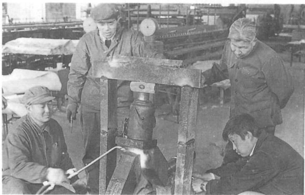
1984年4月，西安市职工技协焊接技术分会的同志在西安地毯厂对大型曲轴断裂进行焊补工艺操作。
