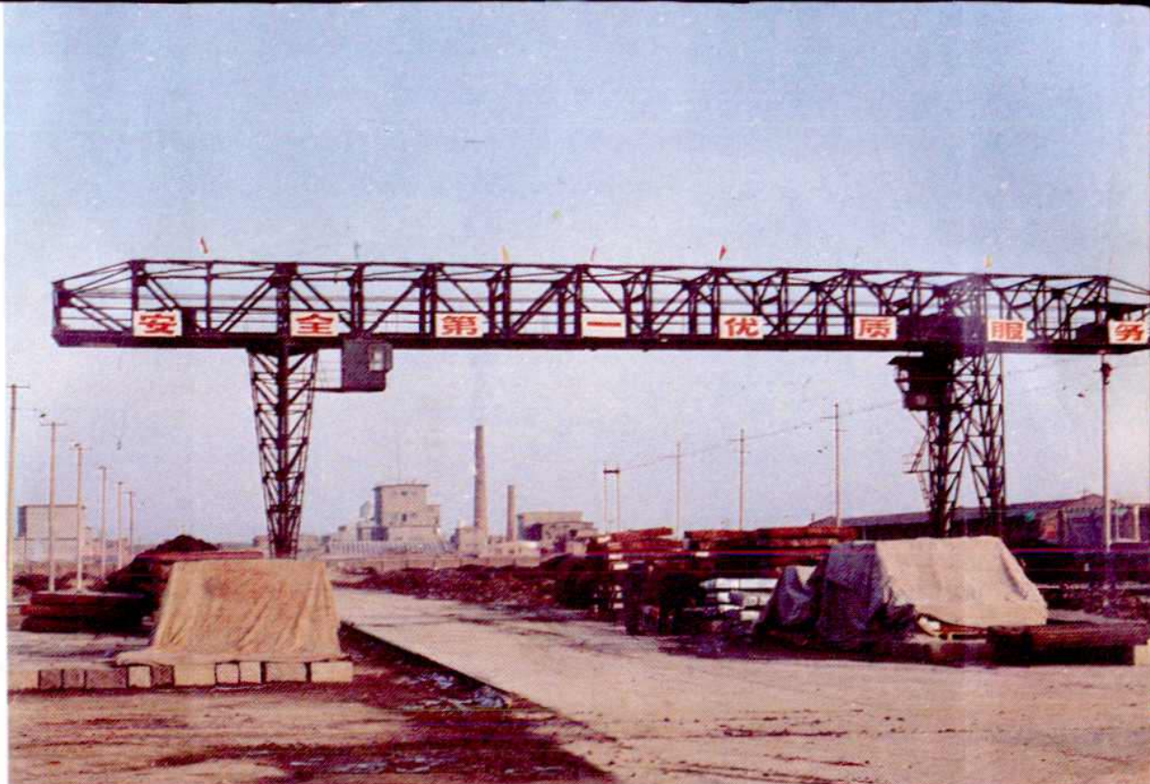
金属材料公司龙门吊
