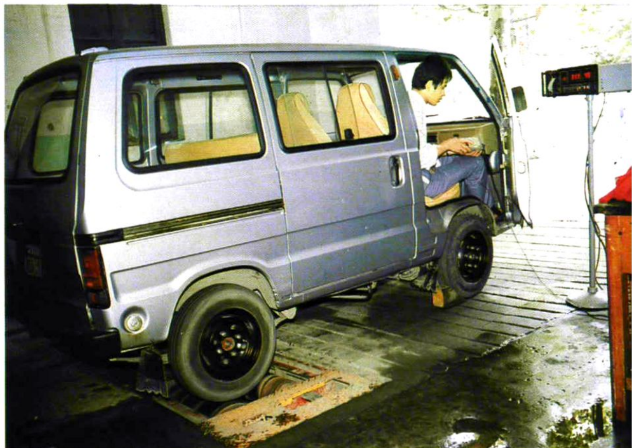
武汉市计量测试检定所的计量人员在检定出租汽车计价器
