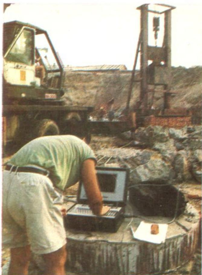
地基基础研究所采用先进的高应变测桩新技术，测定桩基承载能力。
