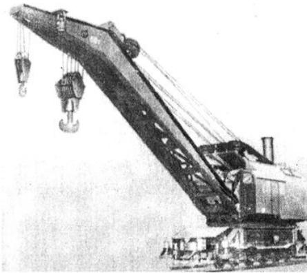
60吨蒸气铁路起重机。
