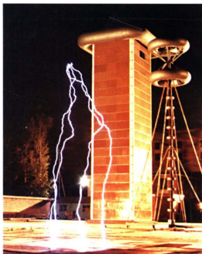
户外6000千伏冲击电压发生器20多米 长间隙冲击电压放电试验
