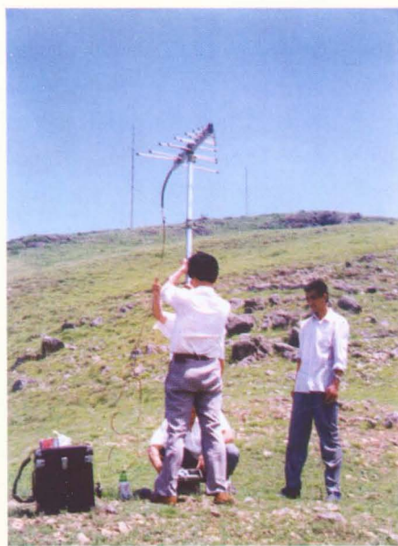
电台技术人员在高山测试广播发射信号。
