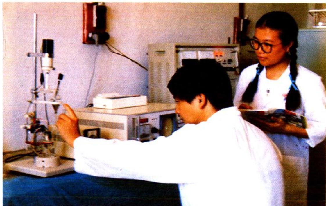
▲县卫生防疫站检验师黄业亚使用 MP—1 型电位溶出分析仪,检测水中的铅、铜、镉等微量元素。
