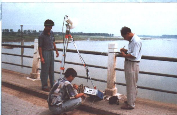
水文人员用电波测速仪施测沂河洪水
