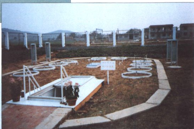
徐州汉王水文水资源实验站南 场蒸渗仪观测设施
