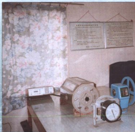
大运河无锡水位站 应答式水位遥讯装置
