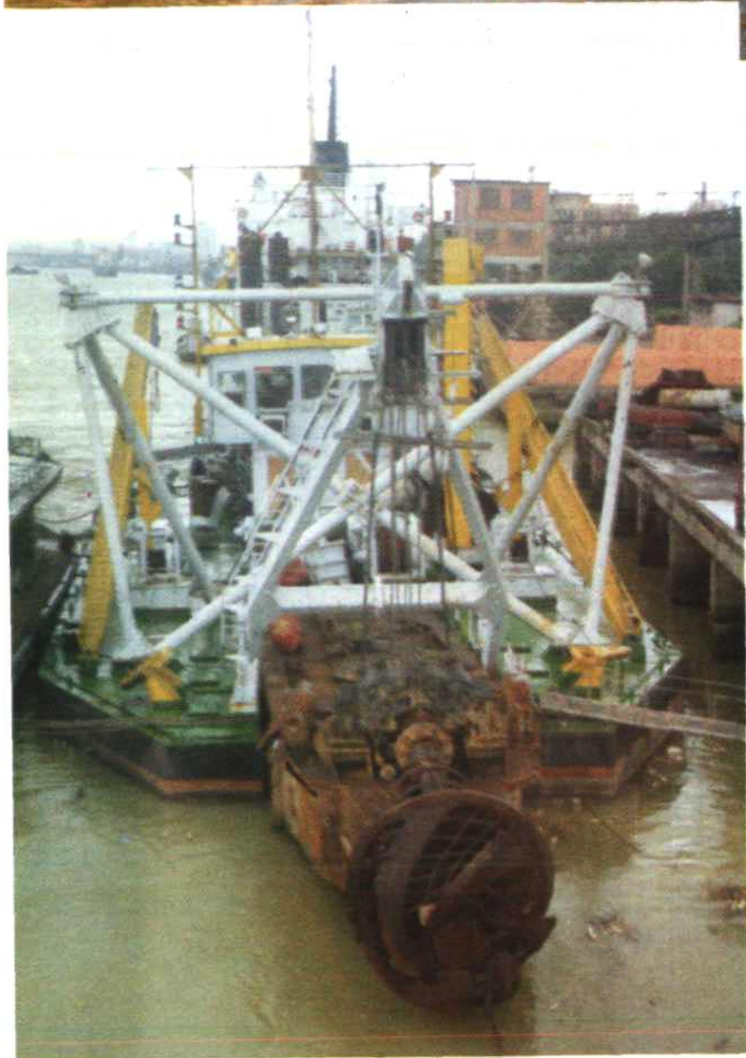
从国外引进由荷兰制造 非标准的海狸3300绞吸 式挖泥船“闽吸168号”
