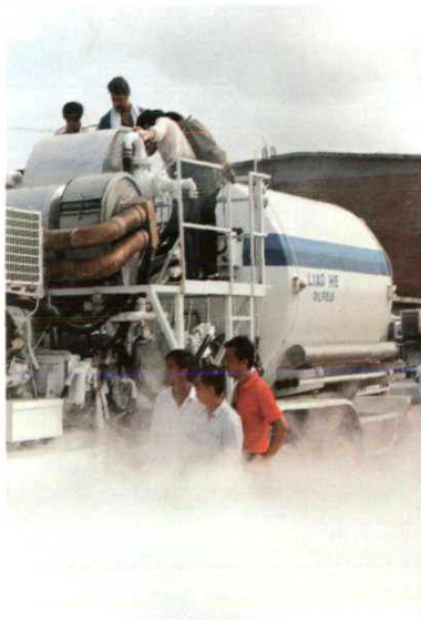
引进液氮压裂设备验收现场
