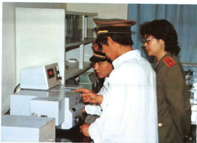
法医工作者正在操作 紫外分光光度计，进行毒物 分析鉴定
