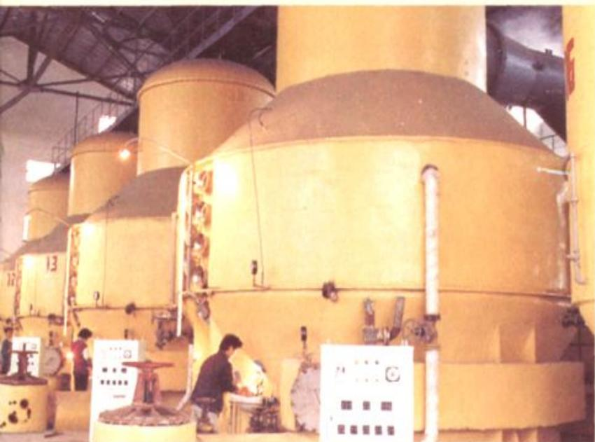
為石灰回溶碳酸法工藝配套的部份設備—— $50\text{m}^3$ 真空結晶罐。
