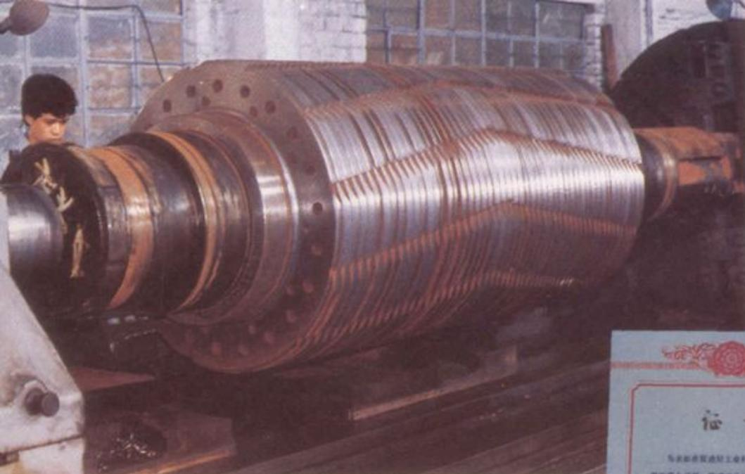
由廣州糖業機械廠採用磷硼鑄鐵工藝鑄成的大型甘蔗壓榨輥正在加工車製中。該產品榮獲1986年輕工業部科學技術進步三等獎（見右下圖）。
