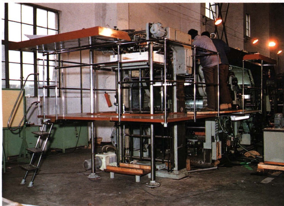
厂生产制造的四色轮转凹印机(82型)
