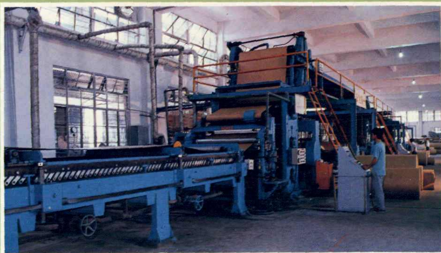
佛山市紙箱包 裝材料總廠引進的 日本瓦楞紙箱板生 產綫
