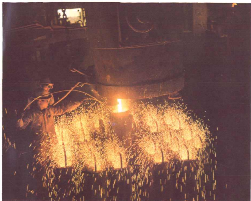
转炉炼钢分厂 工人浇铸沸腾钢
