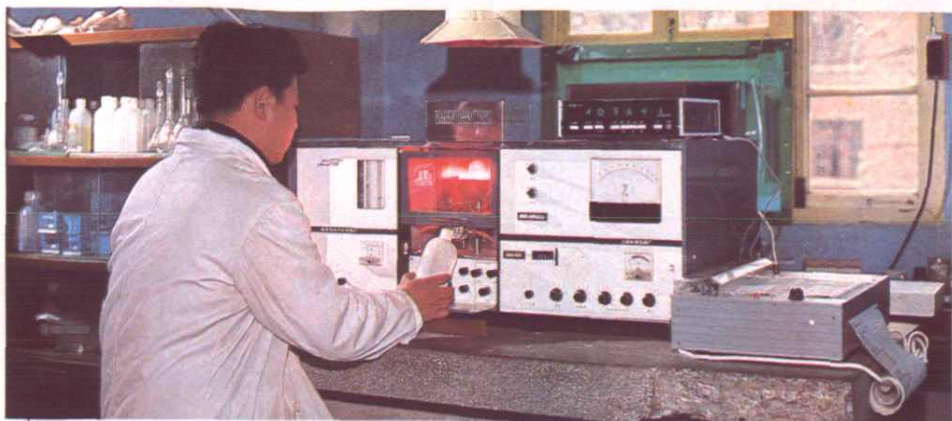
钢铁研究所 化验员使用 原子吸收 分光光度计 分析试样
