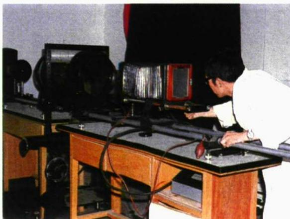
在地震研究所实验室内进行光弹试验
