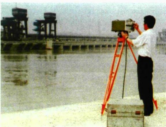
用 JCY-2 型激光测距仪进行水库大坝形变测量
