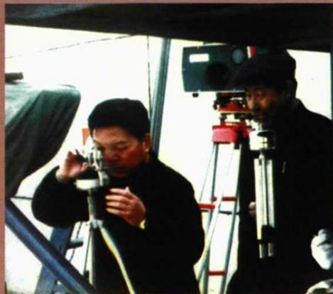
用 JCY-3 型激光测距仪进行海上雷达基线测量
