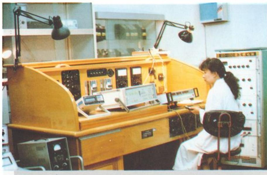
高精度交直流电表检验装置
