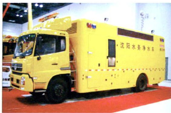
沈阳水务集团有限公司与南京南汽畅通公路机械有限公司联合开发的大出水量应急净水车
