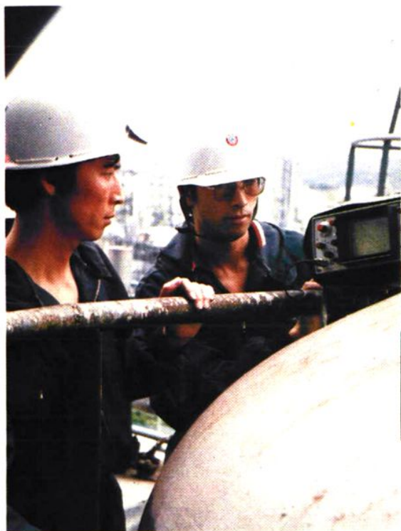
对大型压力容器进行定期检验
