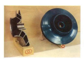
高压锅炉给水泵泵轮
