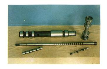
汽轮机备件 门杆、门套、错油门
