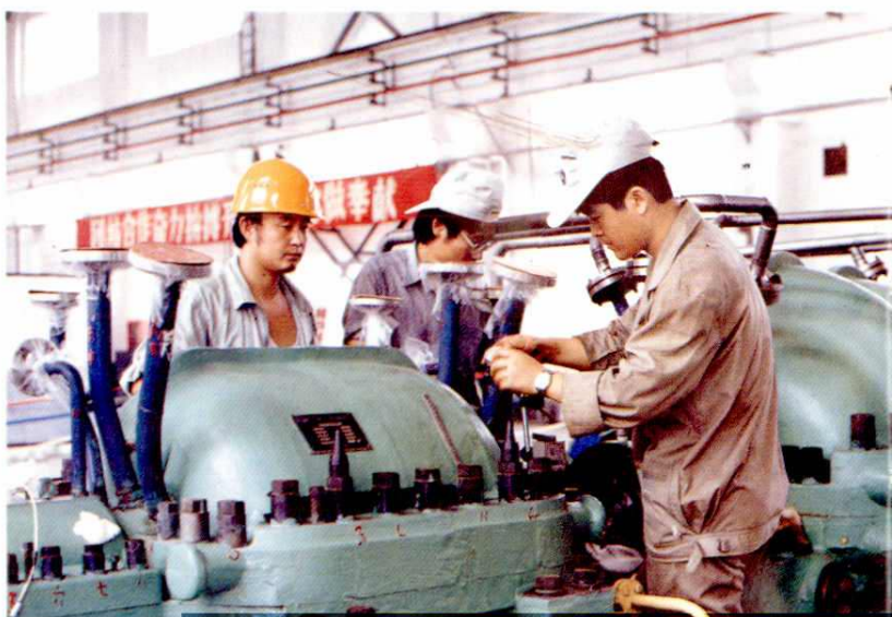
在检修中的氧气压缩机
