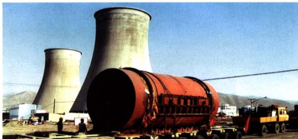
200吨平板车运输红二电158吨发电机定子
