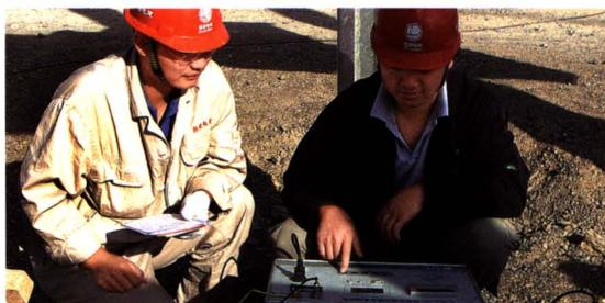
变电站设备耐压试验
