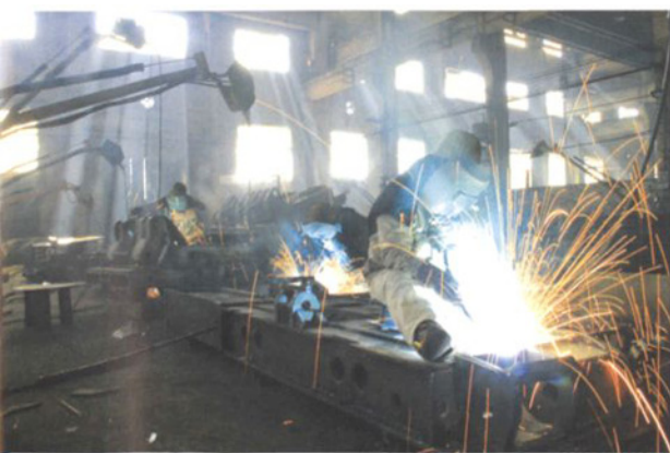
铆焊分公司员工在焊接结构件
