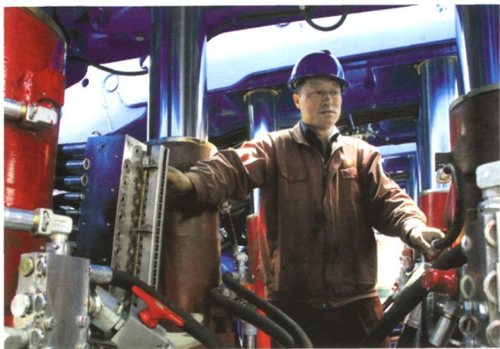
支架分公司员工在调试 ZF8600 电控液压支架
