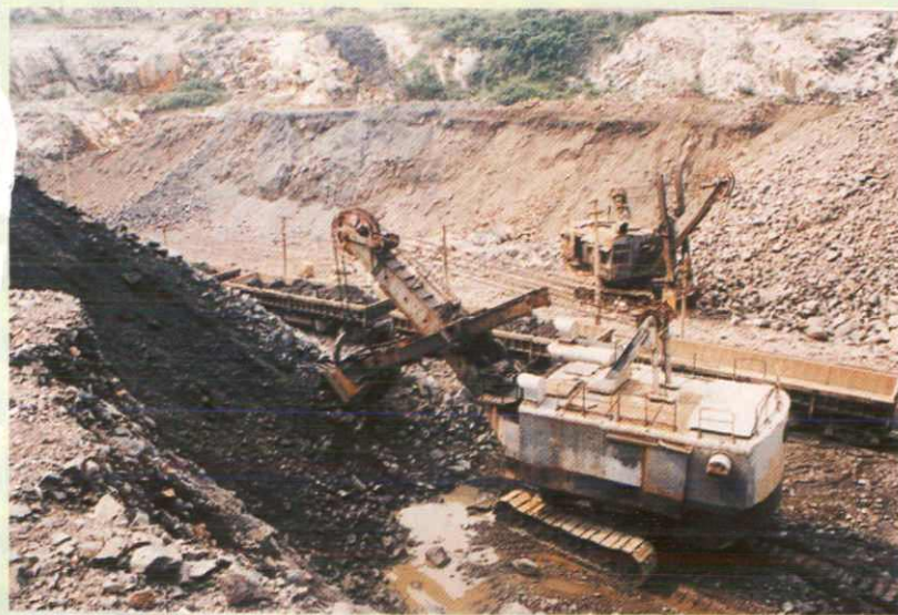
电铲在露天采场转载场装车
