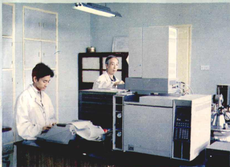
◀“天然气检验测试中心”用 5880 气相色谱仪测定天然气组成
