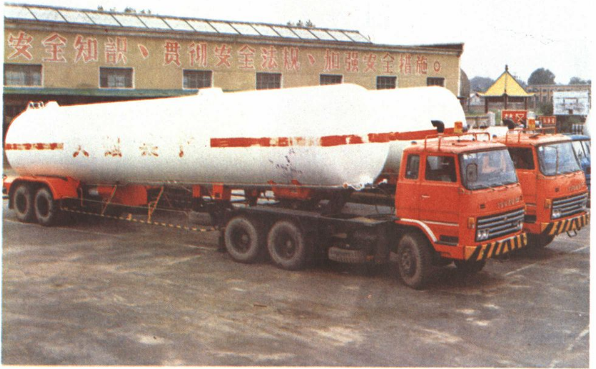
▲ 25吨液化气汽车槽车
