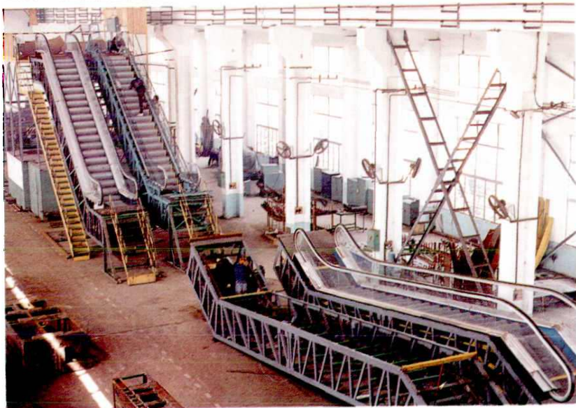
宁波三环自动扶梯制造公司自动扶梯组装调试车间
