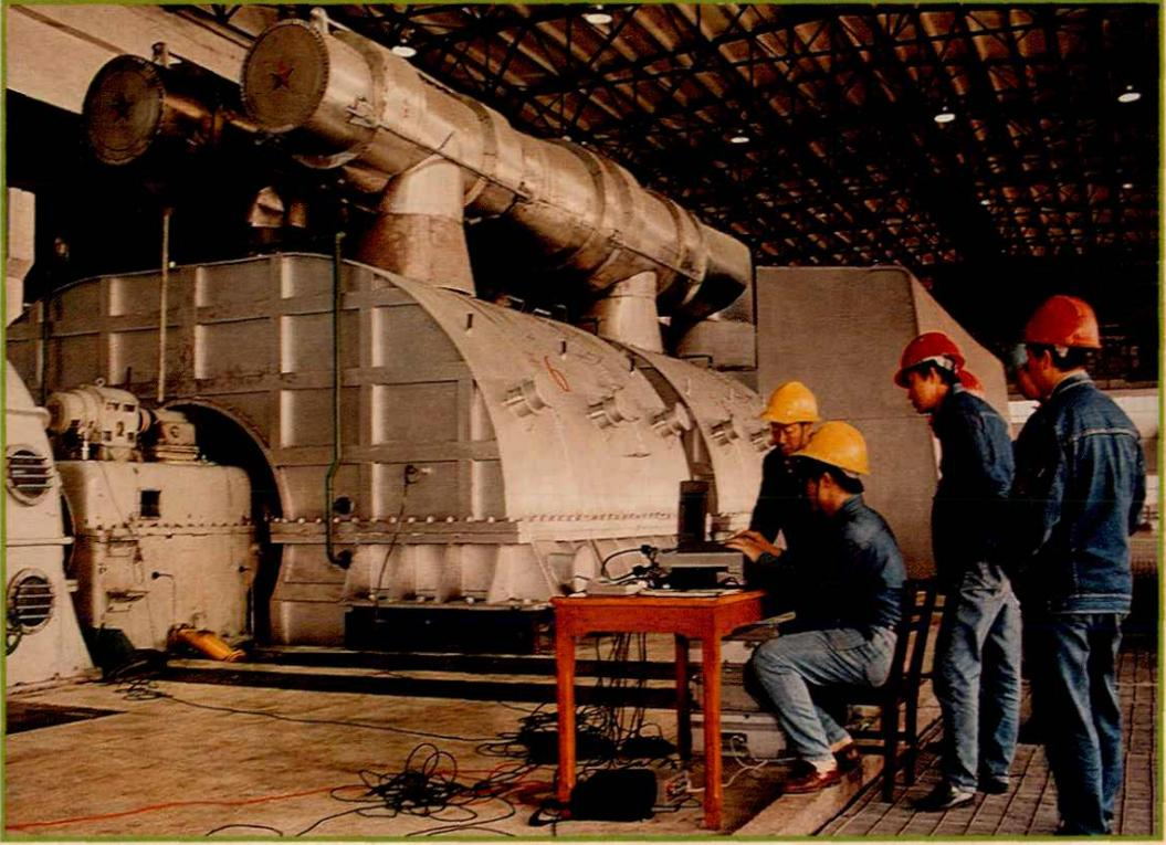
300MW汽轮发电机组振动数据的采集和分析诊断
