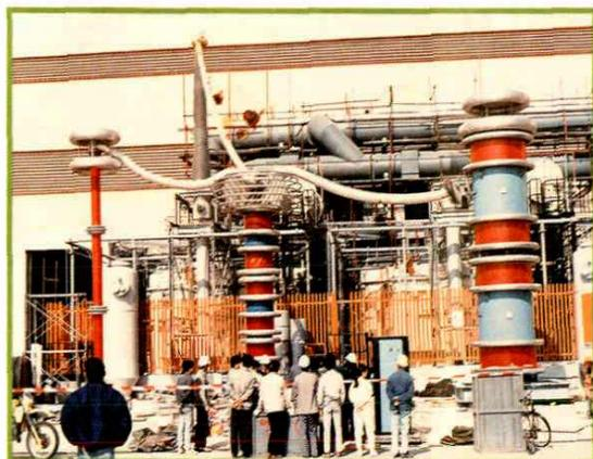
我所自行设计的 CHX — 690 调感式串联谐振耐压装置与进口的 SR — 800 调感式串联谐振耐压装置联合用于大亚湾核电站400kV、500kV GIS交流耐压试验
