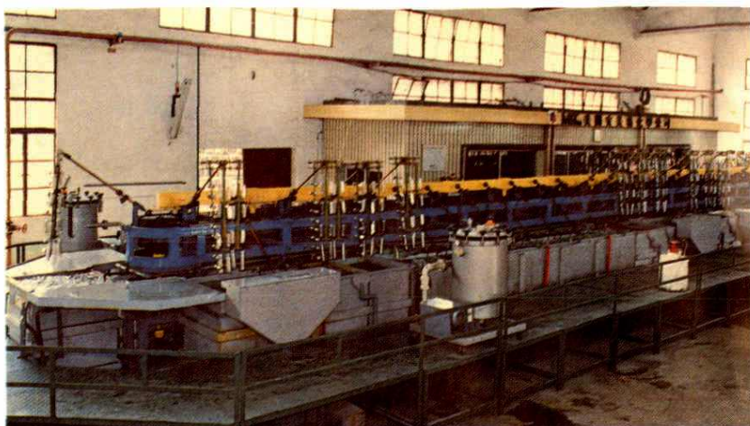
►自贡通明电筒灯具总厂 从美国引进的 3 号光镍铬 电镀生产线
