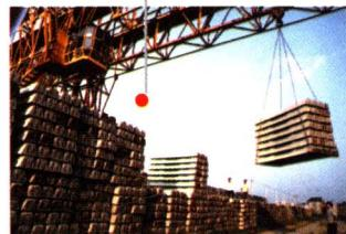
正在发运的Y-F型混凝土轨枕
