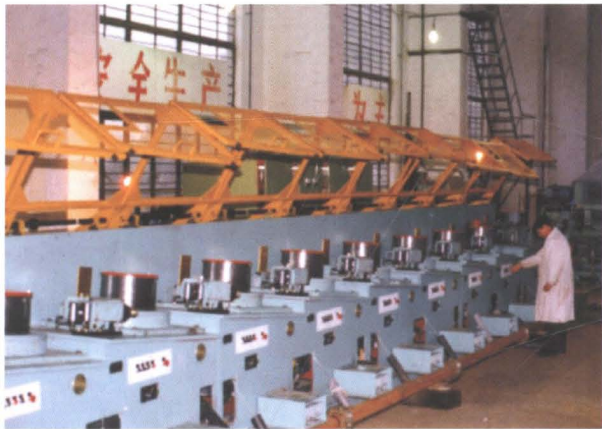
061基地生产的10/400直进式高速拉丝机
