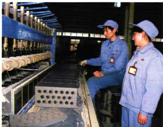
循环经济示范企业——华韵新型建材有限公司煤矸石烧结砖生产线
