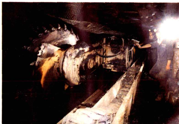
综采工作面 煤机在割煤
